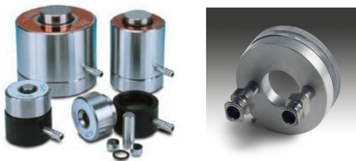
Rysunek 4. Akcesoria stosowane do przygotowania próbki techniką pastylki KBr (po lewej) oraz celka z okienkami spektroskopowymi do pomiaru widm cieczy (po prawej).
