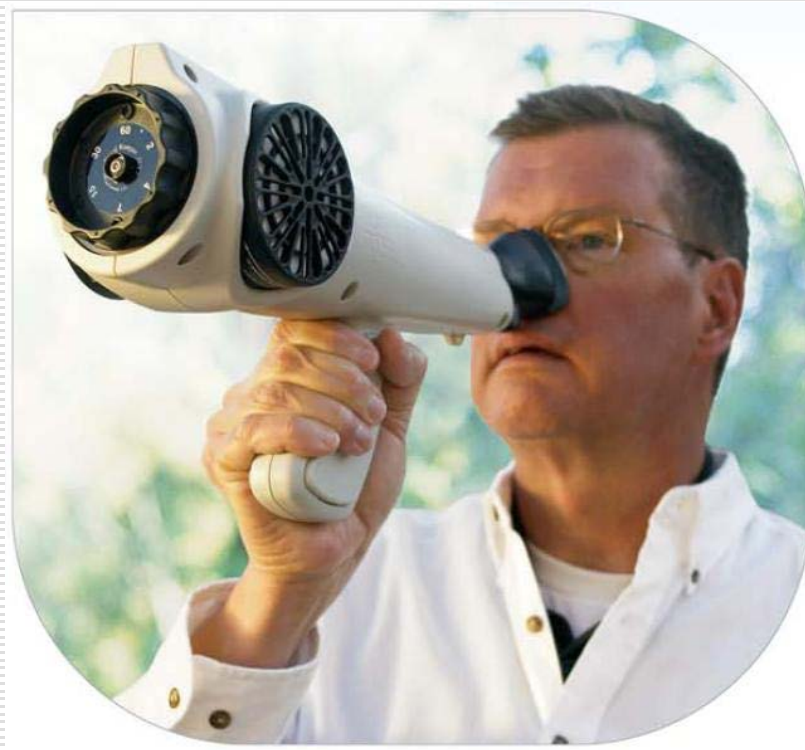
Nasal Ranger - przenośne urządzenie do pomiarów odorów
